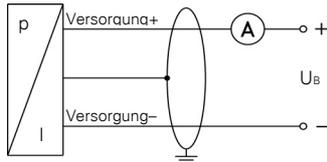
3-Leiter-System (Strom / Spannung)
