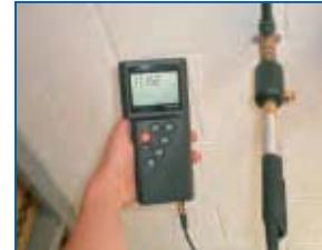
Restfeuchtefühler für Druckluftanlagen (bis 25 bar druckdicht)
