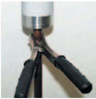
Temperaturmessung an Rohrleitungen (Fühler 6910-0024)
