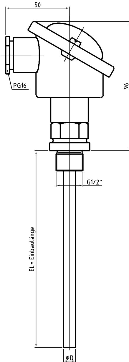
**Einschraub-Widerstandsthermometer Form B,
